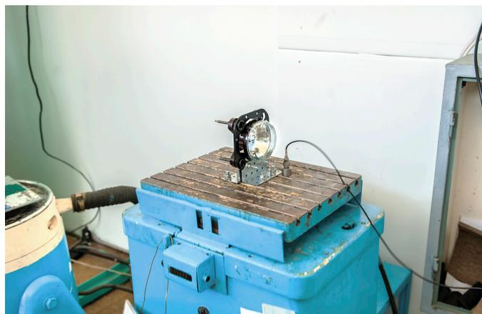
Дополнительно были проведены испытания на воздействие вибрационных и ударных нагрузок согласно ГОСТ 52230 п. 4.20. По завершению испытаний модули работоспособны, не имеют повреждений и поломок после воздействия вибрационных и ударных нагрузок по ГОСТ 52230 п. 4.20.
